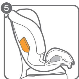
5. Placer le siège de retenue pour enfant en position orientée vers l'avant sur le siège arrière du véhicule. Placer la base bien à plat sur le siège du véhicule. Pousser fermement vers l'arrière jusqu'à ce que l'arrière du siège de retenue pour enfant entre en contact avec le dossier du siège du véhicule. Centrer le siège de retenue pour enfant entre les deux points d'ancrage inférieurs du SAU.
