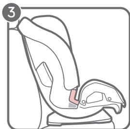
3. Placer le siège rehausseur en position orientée vers l'avant sur le siège arrière du véhicule. L'installer, en position orientée vers l'avant, sur un siège du véhicule muni d'une ceinture de sécurité sous-abdominale/diagonale. La base doit reposer le plus à plat possible sur le siège du véhicule.
