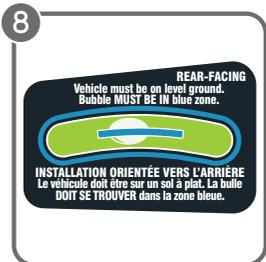
8. Vérifier l'indicateur de niveau. Le véhicule **DOIT** être sur un sol à plat. La bulle doit se trouver entièrement dans la zone bleue. Ajuster l'inclinaison jusqu'à ce que la bulle trouve entièrement dans la zone bleue.
