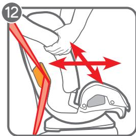
12. Vérifier la tension. Saisir les côtés du siège de retenue pour enfant, là où se trouve le passage de la ceinture en position orientée vers l'avant, et déplacer le siège de retenue pour enfant d'un côté à l'autre et de l'avant à l'arrière. Si le siège de retenue pour enfant se déplace de moins de 2,5 cm (1 po), la tension est suffisante.
