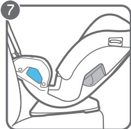
7. Placer le siège de retenue pour enfant en position orientée vers l'arrière sur le siège arrière du véhicule. Placer la base bien à plat sur le siège du véhicule. Pousser vers l'arrière jusqu'à ce que l'avant du siège de retenue pour enfant entre en contact avec le dossier du siège du véhicule.
