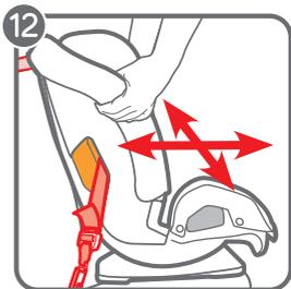
12. Vérifier la tension. Saisir les côtés du siège de retenue pour enfant là où se trouve la courroie du SAU, et déplacer le siège de retenue pour enfant d'un côté à l'autre et de l'avant à l'arrière. Si le siège de retenue pour enfant se déplace de moins de 2,5 cm (1 po), la tension est suffisante.
