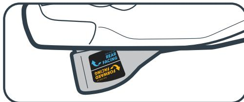
3. Déployer le repose-pieds inclinable. Le repose-pieds inclinable possède 3 positions d'inclinaison. Comprimer le levier d'inclinaison et soulever la base pour déployer le repose-pieds. Comprimer le levier d'inclinaison de la base et l'abaisser pour rétracter le repose-pieds. Consulter l'indicateur de niveau pour vérifier si l'installation est adéquate.
