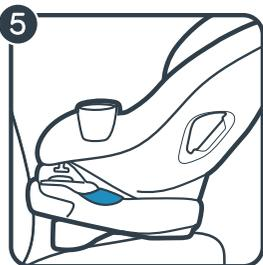
5. Placer le siège de retenue pour enfant en position orientée vers l'arrière sur le siège arrière du véhicule. Placer la base bien à plat sur le siège du véhicule. Pousser vers l'arrière jusqu'à ce que l'avant du siège de retenue pour enfant entre en contact avec le dossier du siège du véhicule.
