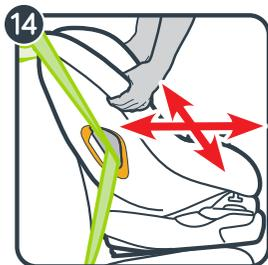
14. Vérifier la tension. Saisir les côtés du siège de retenue pour enfant, là où se trouve le passage de la ceinture en position orientée vers l'avant, et déplacer le siège de retenue pour enfant d'un côté à l'autre et de l'avant à l'arrière. Si le siège de retenue pour enfant se déplace de moins de 2,5 cm (1"), la tension est suffisante.
